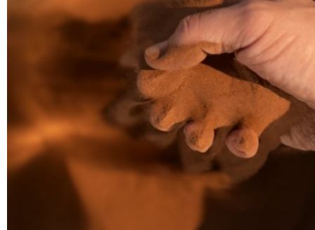
Feinkörnige Asche aus der Staubfeuerung
