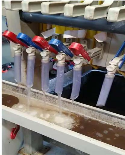
Filtratgewinnung in der Kammerfilterpresse
