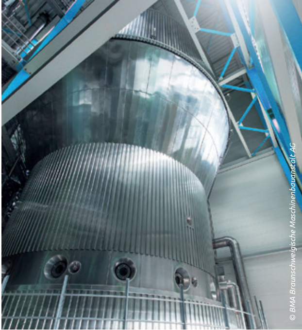
Bild 2: Beispiel eines Wirbelschichtverdampfungstrockners, der an Klärschlamm anzupassen ist.
